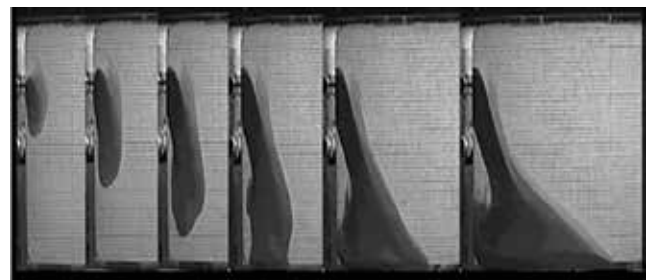
Hình 5. Chiều dài khe nứt khi bơm có đáp ứng chiều dài khe nứt theo thiết kế (nguồn: P.E Clark, 2006)
